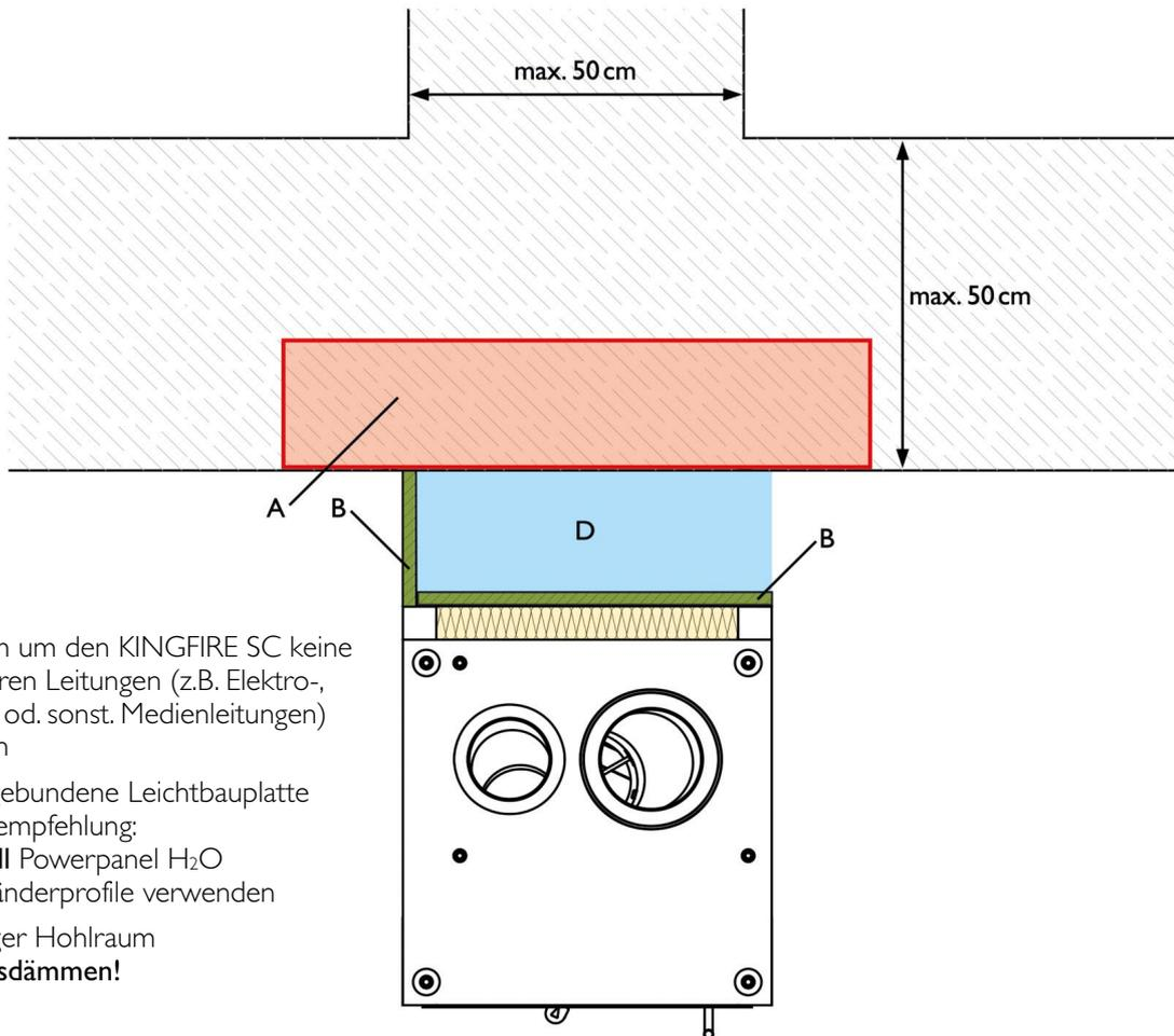
**A** - bis 20 cm um den KINGFIRE SC keine brennbaren Leitungen (z.B. Elektro-, Wasser- od. sonst. Medienleitungen) verbauen
