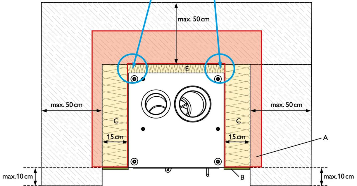
**A** - bis 20 cm um den KINGFIRE SC keine brennbaren Leitungen (z.B. Elektro-, Wasser- od. sonst. Medienleitungen) verbauen
