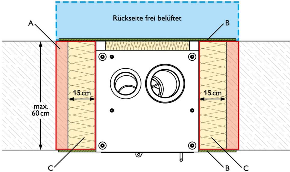
A - bis 20 cm um den KINGFIRE SC keine brennbaren Leitungen (z.B. Elektro-, Wasser- od. sonst. Medienleitungen) verbauen
