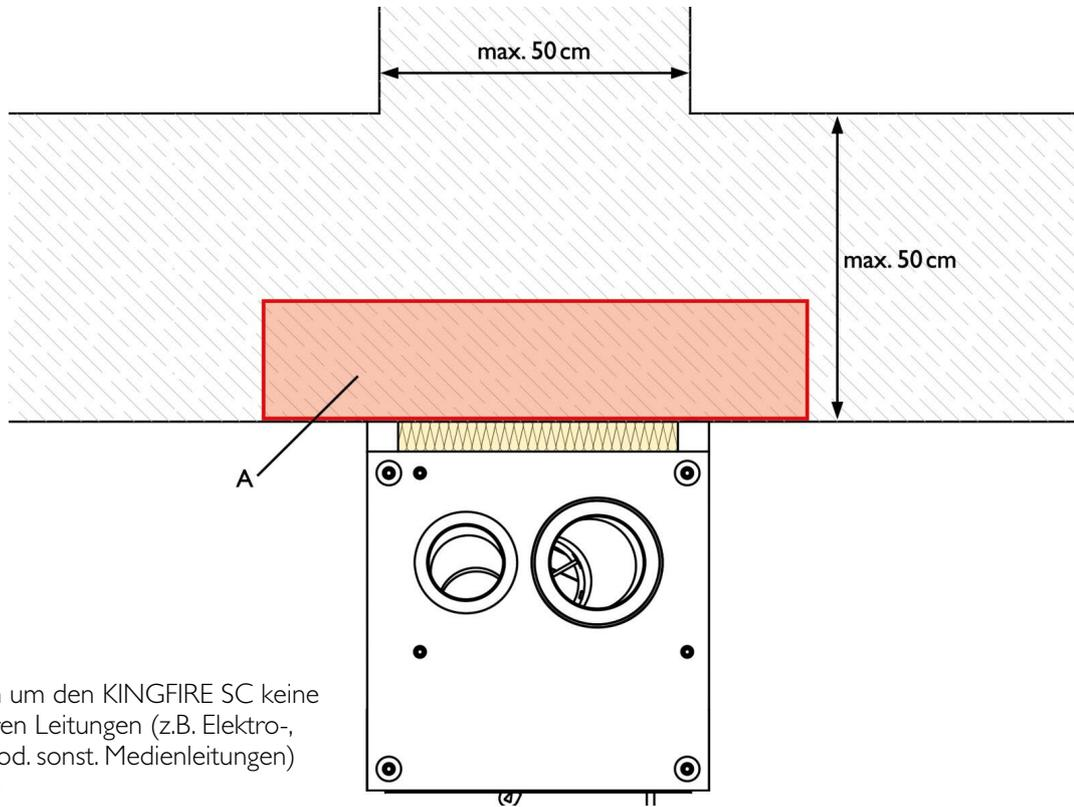
A - bis 20 cm um den KINGFIRE SC keine brennbaren Leitungen (z.B. Elektro-, Wasser- od. sonst. Medienleitungen) verbauen
