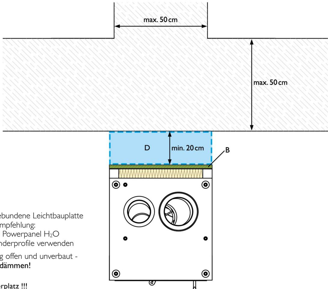
**B** - zementgebundene Leichtbauplatte
