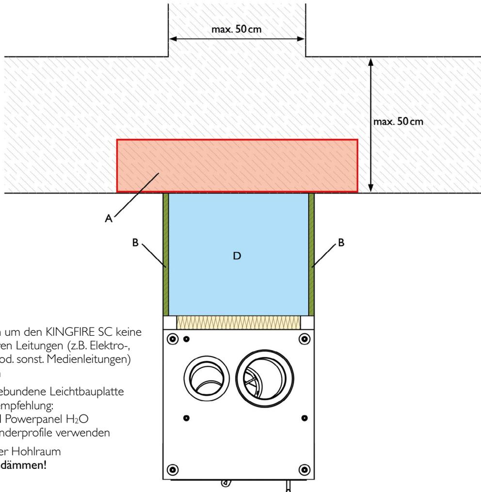
A - bis 20cm um den KINGFIRE SC keine brennbaren Leitungen (z.B. Elektro-, Wasser- od. sonst. Medienleitungen) verbauen
